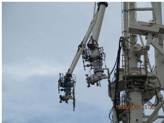
รูปที่ 3-34 Double Valves ป้องกันกรณีที่เราเคลื่อนตัวออกจาก Loading Arm
